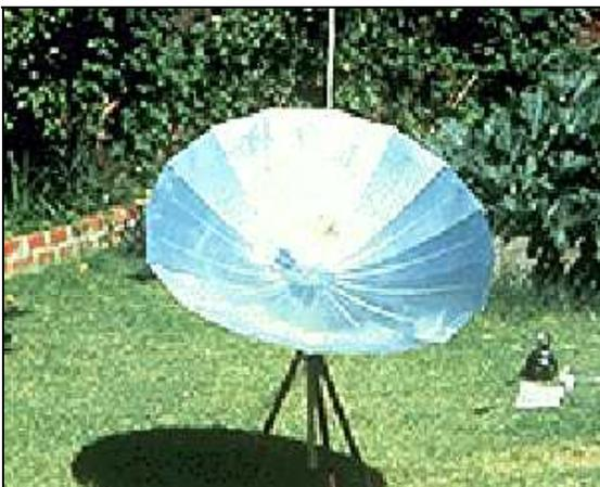
Figura #4.- Cocina solar de concentración. Se aprecia la olla color negro que contiene el alimento y que se colocará en el foco del paraboloide.
