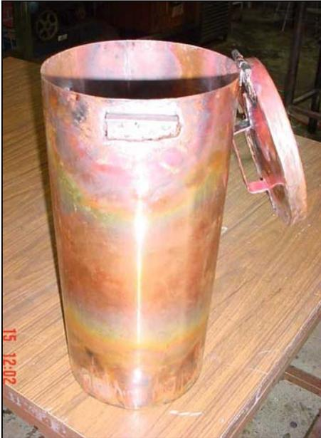
Figura #10.- Olla de cobre de hasta 6 litros de capacidad fabricada específicamente para el tanque de almacenamiento en cuestión. Se aprecia la tapa de la misma.
