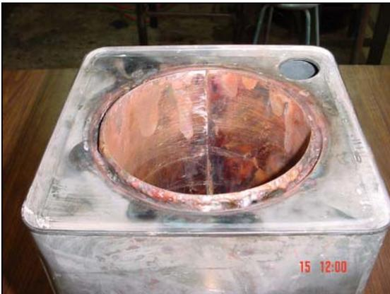
Figura #9.- Vista superior del tanque de almacenamiento y su contenedor de cobre para un intercambio eficiente de calor hacia la olla.
