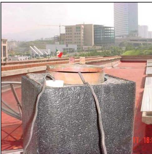
Figura #13.- Se aprecian los termopares, uno para la temperatura del fluido térmico dentro del tanque y otro para la temperatura de los alimentos (agua) dentro de la olla.
