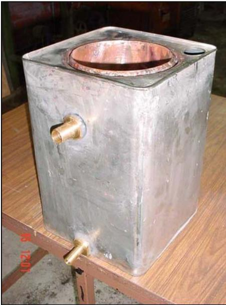
Figura #8.- Tanque de almacenamiento del fluido térmico. Se aprecia el contenedor de cobre dentro del cual se coloca la olla.
