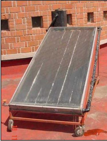
Figura #6.- Aspecto general de la cocina solar con fluido térmico en termosifón. Se aprecia el calentador solar plano y el tanque de almacenamiento conteniendo la olla.
