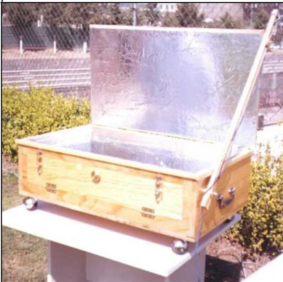
Figura #2.- Horno solar tipo caja construido de madera.
